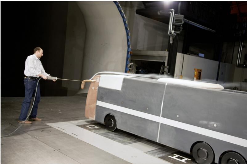
Die Comfort Class 500 wurde anhand eines Modells im Maßstab 1:2,5 im Daimler-Windkanal optimiert.
