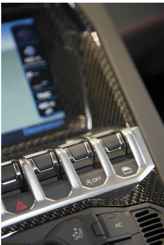
Der Lamborghini Aventador LP 700-4 verfügt über ein Start-Stop-System.
