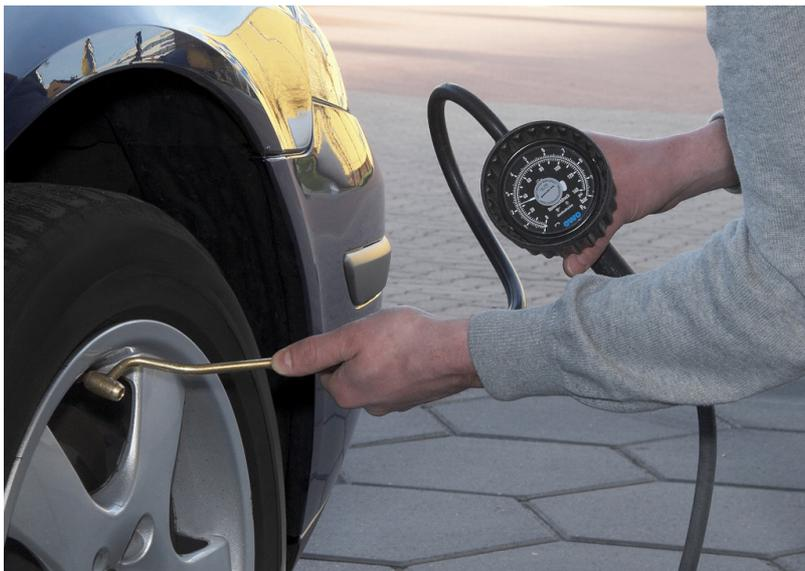
Überprüfung des Luftdrucks eines Autoreifens.
