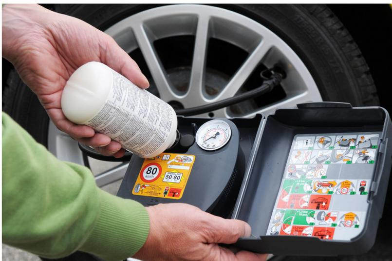
Aufpumpen eines Reifens mittels Kompressor aus dem Pannenset.
