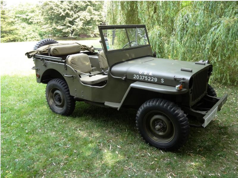
Willys MB von 1944. Insgesamt gebaut 361 349 Exemplare, Vier-Zylinder-Benziner, 2199 ccm, 100 km/h Höchstgeschwindigkeit, 0 auf 80 km/h in 19 Sekunden.
