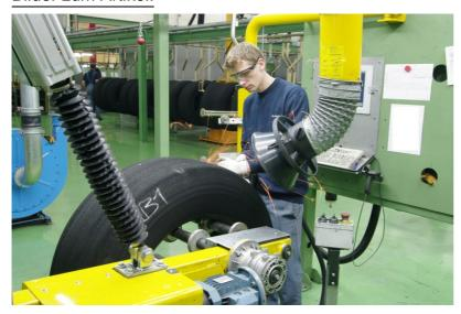
Runderneuerung von Lkw-Reifen bei Goodyear Dunlop.
