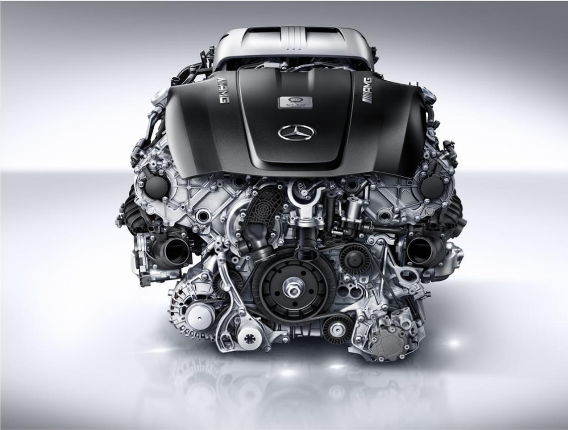
Mercedes-AMG GT: AMG V8-Zylinder-Benzinmotor mit Biturboaufladung, Baureihe M178, V-Anordnung der Kolben, Kurbelwelle, Turbolader.
