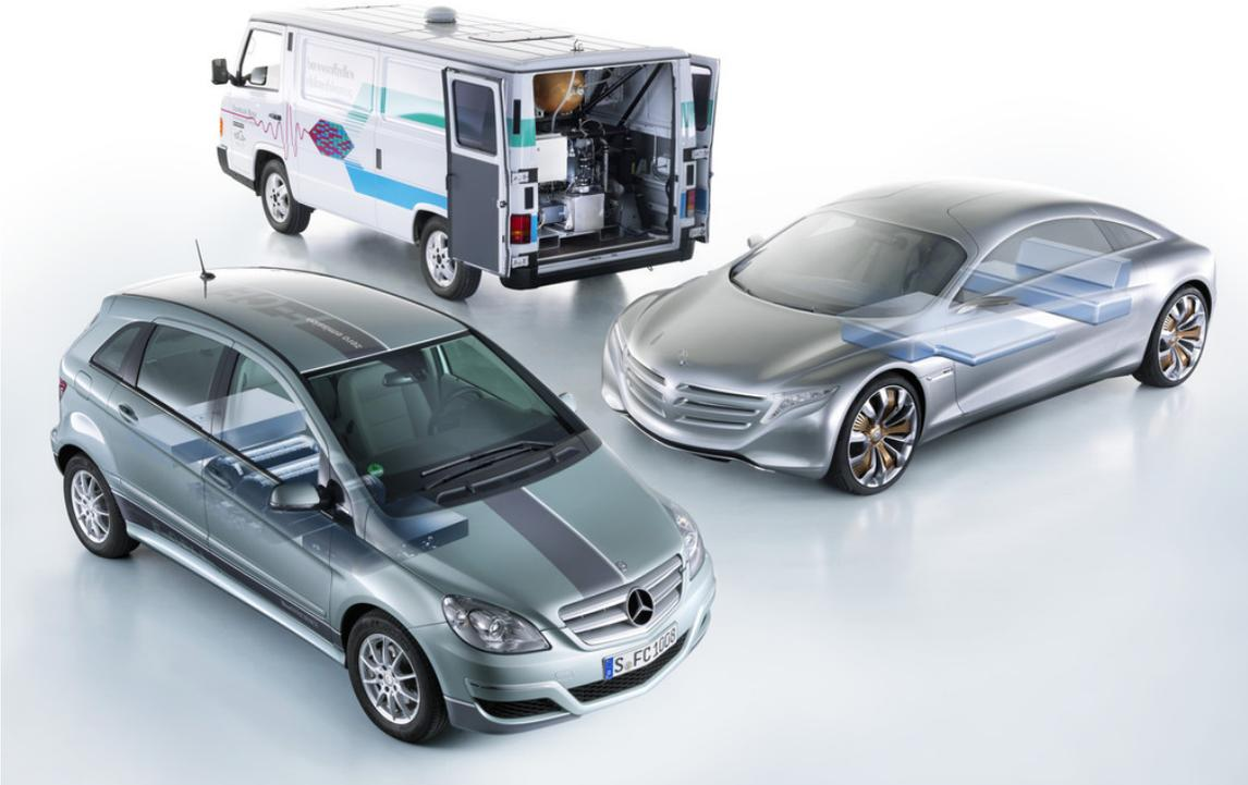
Brennstoffzellen bei Mercedes-Benz: Es begann 1993 mit einem Transporter MB 100. Die Brennstoffzellen- und Messtechnik an Bord wog 800 Kilogramm.
