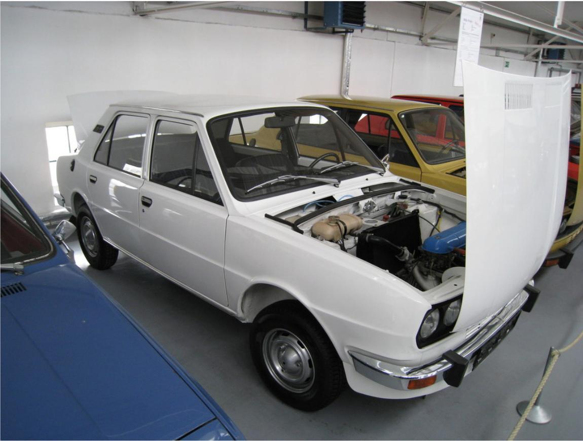
Skoda 120 Prototyp mit Frontmotor und -antrieb.
