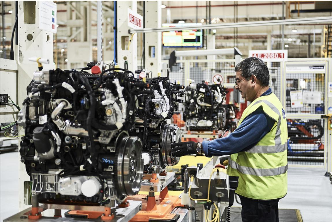
Produktion des 2,0-Liter-Ecoblue-Dieselmotors bei Ford.
