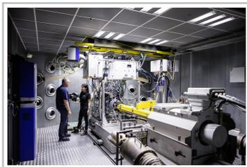
Reihen-Sechs-Zylinder-Ottomotor M 256 von Mercedes-Benz auf dem Prüfstand.
