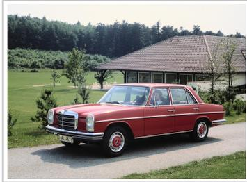
Mercedes-Benz 280 der Baureihe W 114. Die beiden 1972 eingeführten „Strich-Acht“-Topmodelle verfügen über eine Doppelstoßstange vorn und eine bis zum Radausschnitt vorgezogene Heckstoßstange.
