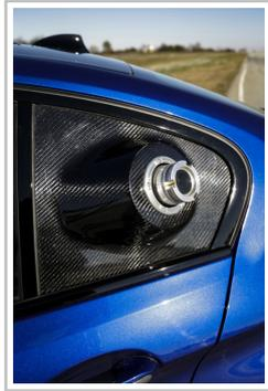
Tankeinfüllstützen für den Driftrekord mit dem BMW M5.
