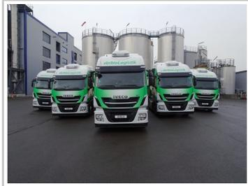
Verbio Logistik setzt fünf Iveco Stralis NP 440S40 CNG ein, die mit zu 100 Prozent aus Stroh gewonnenem Methan betrieben werden.
