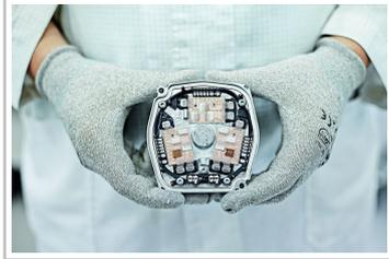
Steuerungsmodul von Hella für die elektrische Servolenkung.
