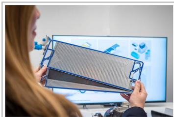
Brennstoffzelle mit Minus- und Pluspol vorn und hinten sowie der Membran in der Mitte.
