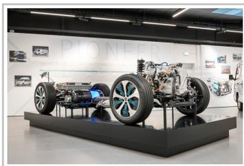
Das Innenleben des GLC F-Cell: Brennstoffzelle vorn, Wasserstofftank in der Mitte und dem zweiten Tank sowie Batterie und Motor hinten.
