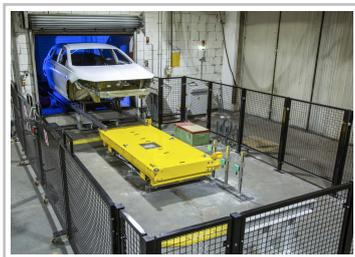
Opel Exclusive: Die Rohkarosse wird ausgeschleust und verlässt vorübergehend die standardisierte Fertigungslinie.
