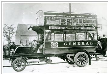
Ab 1904 baute Büssing insgesamt 400 Fahrgestelle für England, die als Unterbau für die ersten Londoner Oberdeck-Omnibusse dienten.
