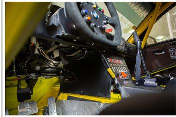
Schaeffler Paravan hat einen BMW M4 mit der Drive-by-wire-Technologie Space Drive II ausgerüstet, bei der die Lenkbefehle nicht über eine klassische Lenksäule, sondern elektronisch an Servomotoren übermittelt werden.
