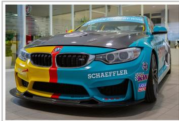
Schaeffler Paravan hat einen BMW M4 mit der Drive-by-wire-Technologie Space Drive II ausgerüstet, bei der die Lenkbefehle nicht über eine klassische Lenkstange, sondern elektronisch an Servomotoren übermittelt werden.
