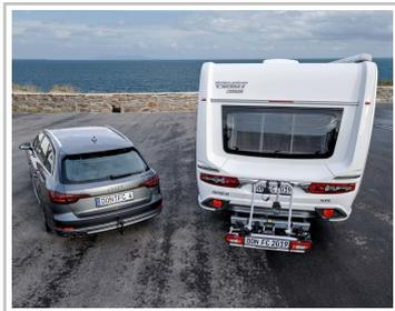
Kugelkupplung AI-Ko Carryback mit Fahrradträger an einem Fendt-Caravan.
