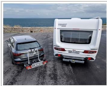
Für den Heck-Fahrradträger: Ausziehbare Kugelkupplung AI-Ko Carryback am Wohnwagen.
