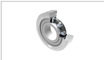
Schaeffler hat sein Schwenklager mit einer speziell gekrümmten „Kugelkappe“ (Kalotte) ausgestattet. Es kann in sich selbst verkippen und somit das Schwenken der Schneckenwelle kompensieren.
