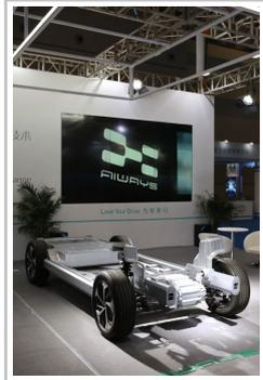
Batterie-elektrische Plattform mit Methanol-Brennstoffzelle von Aiways.
