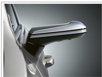
Kameragestützter Außenspiegel des Lexus ES 300h.
