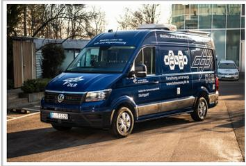
Mit einem umgerüsteten Transporter kann das Deutsche Zentrum für Luft- und Raumfahrt Feinstaubemissionen und gasförmige Schadstoffe sehr genau messen.
