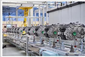
Produktion hochintegrierter E-Antriebe im BMW-Werk Dingolfing.
