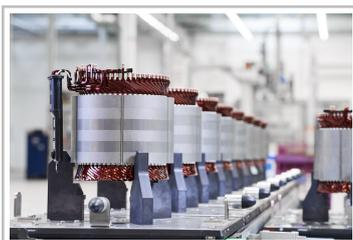
Produktion hochintegrierter E-Antriebe im BMW-Werk Dingolfing.
