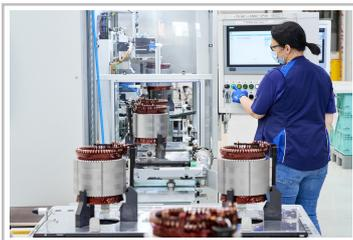
Produktion hochintegrierter E-Antriebe im BMW-Werk Dingolfing.
