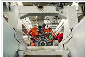
Ein Scania-Motor von Scania wird in einen Perlini-Muldenkipper eingebaut
