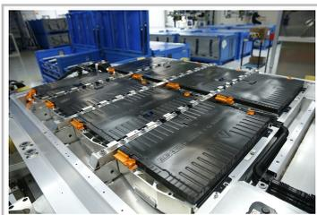
Batterieproduktion im BBA-Werk Tiexi (China).
