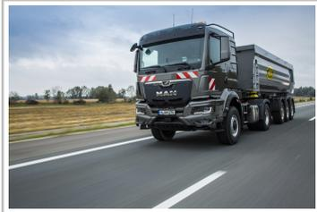
MAN TGS Kippsattelzugmaschine mit hydrostatischem Vorderradantrieb.
