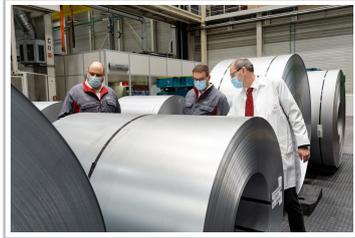
Durch Prelube II spart Audi im Presswerk Ingolstadt pro Jahr 40 Tonnen Öl ein. Dr. Ingo Faaß, Robert Hozjan (beide vom Betriebsmanagement des Presswerks) und Martin Michallek (Fertigungsplanung Lackiererei) kontrollieren die Grundbeölung bei Stahlcoils mit dem neuen Schmiermittel.
