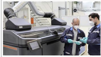
Prototyp des Spezialdruckers für Binder-Jetting im
