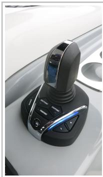
Leichter langsam manövrieren: Joystick des Helm-Master-EX-Systems für die Außenbordmotoren von Yamaha.
