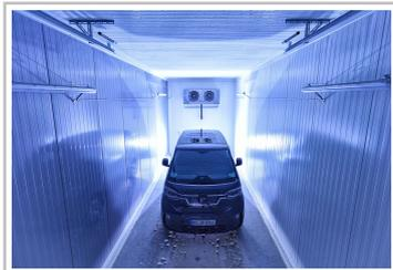
Prototyp des VW ID Buzz in der Klimakammer.
