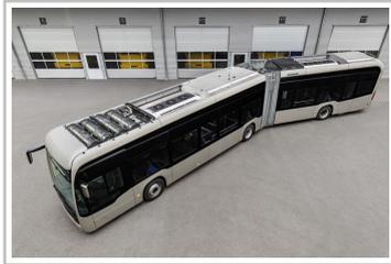
Mercedes-Benz e-Citaro G Range Extender mit Brennstoffzellentechnik von Toyota.
