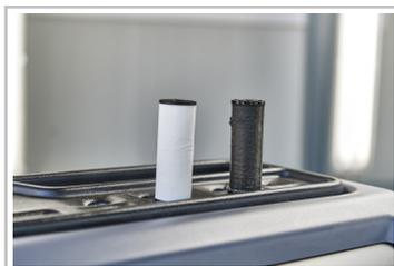
Getriebeölwechsel: neuer und alter Filter.
