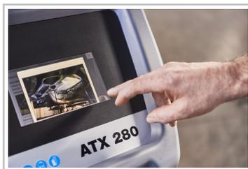
Das Getriebeölservicegerät Mahle ATX 280 verfügt über einen fotorealistischen Touchscreen.
