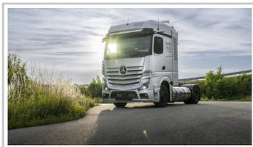
Prototyp des Mercedes-Benz GenH2 Truck mit Flüssigwasserstoff.
