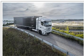
Prototyp des Mercedes-Benz GenH2 Truck mit Flüssigwasserstoff.
