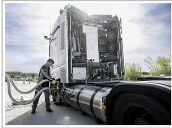
Prototyp des Mercedes-Benz GenH2 Truck mit Flüssigwasserstoff.
