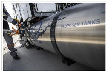
Prototyp des Mercedes-Benz GenH2 Truck mit Flüssigwasserstoff.
