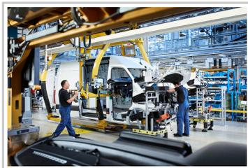
Produktion des e-Sprinter im Mercedes-Werk Düsseldorf.
