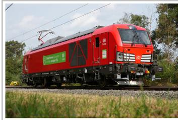
So genannte Zweikraftlokomotive der DB Cargo vom Typ Vectron Dual Mode für den Betrieb auch mit Biokraftstoff.
