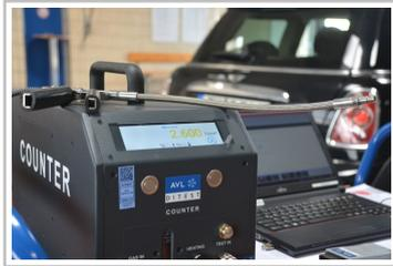
Partikelmessgerät für Euro-6-Dieselfahrzeuge.
