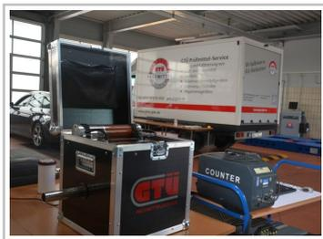
Partikelmessgerät für Euro-6-Dieselfahrzeuge in einer GTÜ-Prüfstation.
