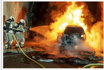
Brand- und Löschversuche mit Elektroautos im Tunnel.
