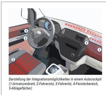
Grafik zur Darstellung der Integrationsmöglichkeiten von Heizelementen im Cockpit.
