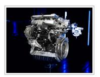
2,0-Liter-Wasserstoff-Turbomotor von AVL Racetech.
