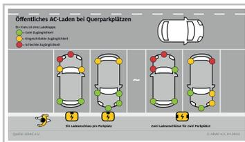
Hinten oder vorn, links oder rechts: Für die Ladeklappe am Elektroauto gibt es unterschiedliche Positionen.
